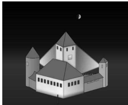
Figur 16 Aus erhöhter Position beleuchten Lichtprojektoren mit Masken das Gebäude, sodass nur ein sehr geringer Teil des Lichts an der Sehenswürdigkeit vorbei in die Umgebung gelangt.
