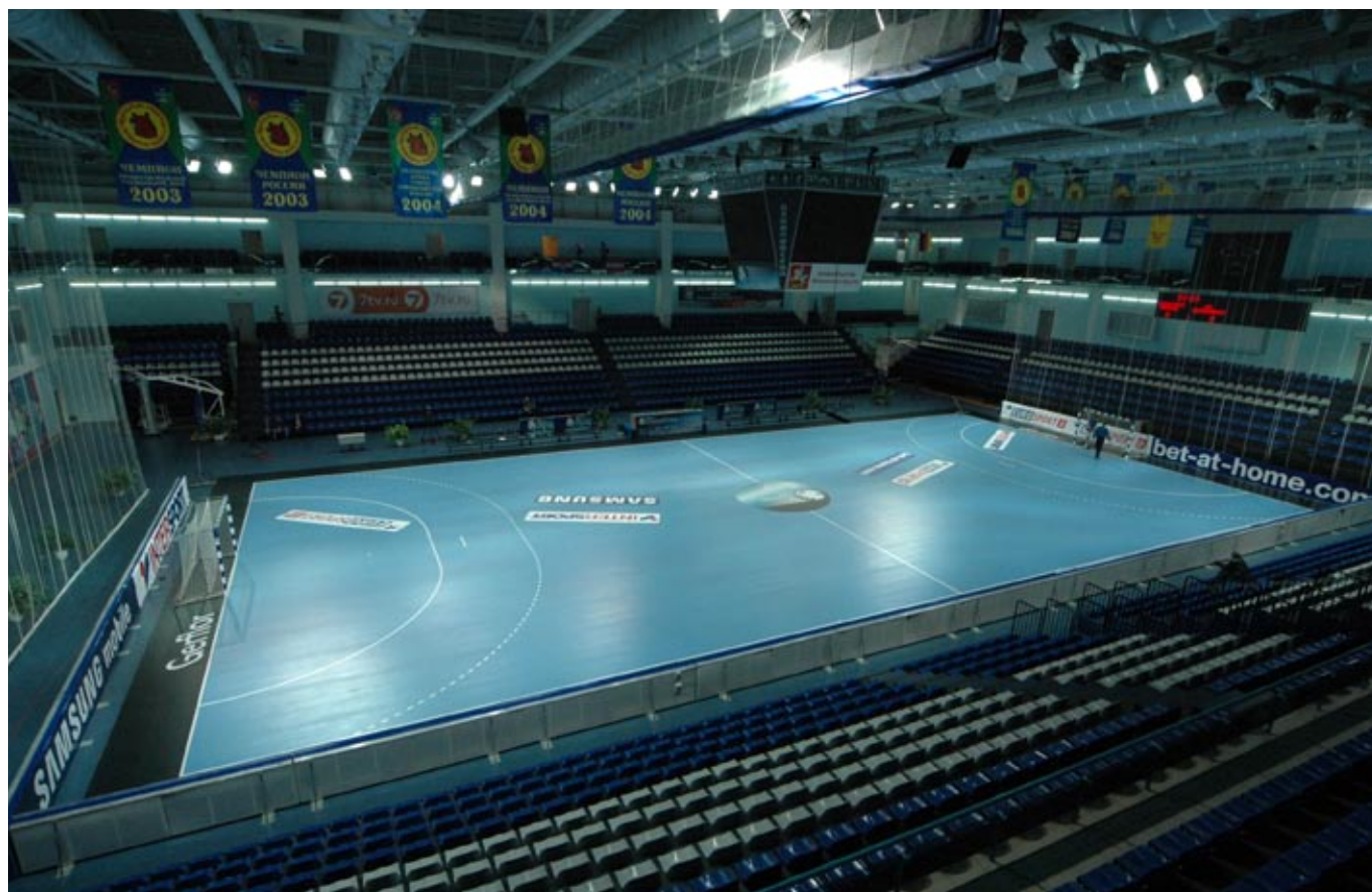
Mobiler Handballboden von der Rolle, hier mit PVC-Nutzschicht, wird nicht mit dem Untergrund verklebt.
