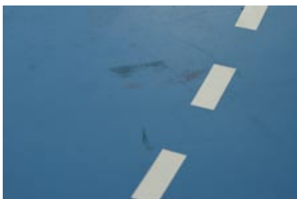
PVC-Nutzschicht mit Struktur
